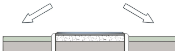
Рисунок 1. Схема примыкания газона к бортовому камню
