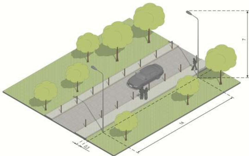
Второстепенные внутриквартальные проезды, совмещенные с пешеходными путями, следует освещать светильниками на опорах высотой до 7 м с асимметричным светораспределением и дополнительной обратной засветкой. Соотношение высоты светильников и шага опор рекомендуется принимать 1:3 (15–20 м).
