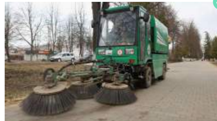
Ширина дорожки и толщина мощения учитывает возможность очистки специальной техникой
